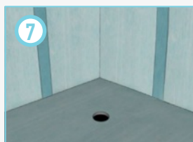
7 Наклеить на всю поверхность пола мембрану TH2 Stop
